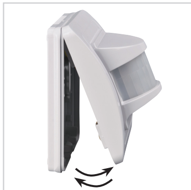
Obr.4 Nasaďte díl s elektronikou na spodní část a zajistěte pojistným šroubem.
