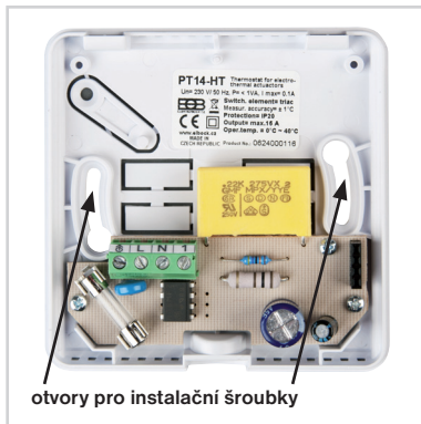
Obr.4 Nasadte díl s elektronikou na spodní část a zajištěte pojistným šroubem.
