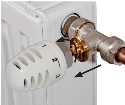
4.2 Pomocí vhodného šroubováku otočte páčku HD13 směrem nahoru a vysuňte převodovou část z těla hlavice.
