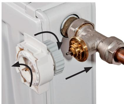
4.4 Uchopte těleso hlavice displejem směrem nahoru, zkontrolujte zda páčka západky směřuje také vzhůru. Potom těleso naklápnete z vrchu dolů na ventil s převodovou částí.
