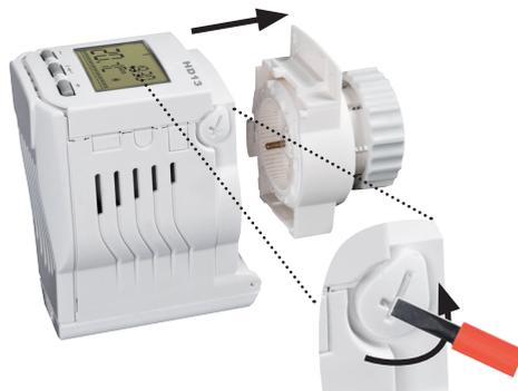
4.3 Uchopte převodovou část hlavice HD13, vyšroubujte ozubené kolečko proti směru hodinových ručiček až na doraz. Nasadte převodovou část s maticí na ventil a rukou dotáhněte matici na ventil (NEPOUŽÍVEJTE ŽÁDNÉ NÁSTROJE!).
