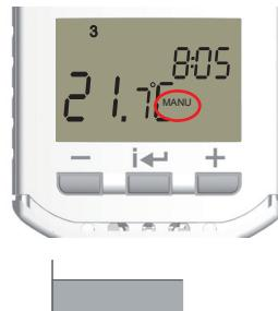
V režimu MANU pracuje hlavice dle jedné nastavené teploty, dokud není ručně změněna.
