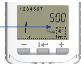
Nastavte teplotu nebo tlačítky / pro 1.změnu a potvrďte tlačítkem .
