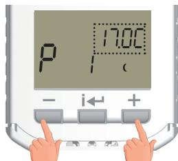
Tlačítky / nastavte příslušnou hodnotu a potvrďte tlačítkem .
